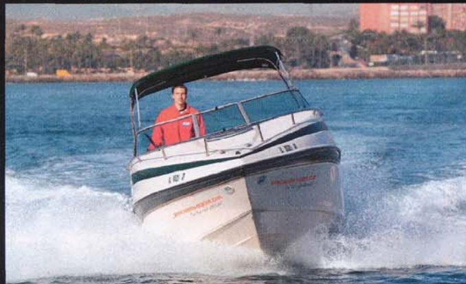
Flap bâbord baissé au maxi et flap tribord relevé, le bateau gîte sévèrement. Puis nous enclenchons le système ACS...
