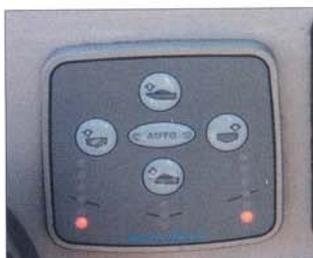
Ce petit tableau de commandes à diodes lumineuses remplace vos boutons et indicateurs de flaps traditionnels.
