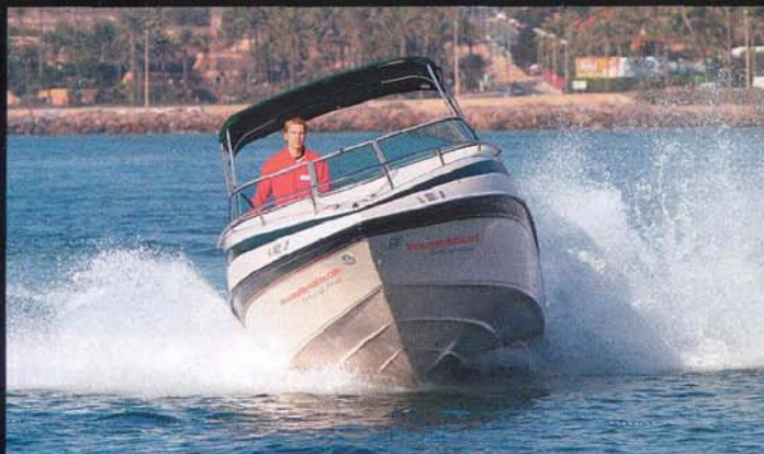
Flap bâbord baissé au maxi et flap tribord relevé, le bateau gîte sévèrement. Puis nous enclenchons le système ACS...
