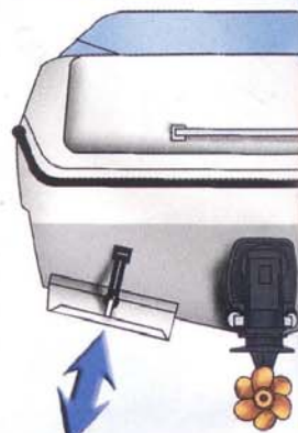
L'ACS joue sur le trim pour limiter le cabrage ou éviter l'enfournement...
