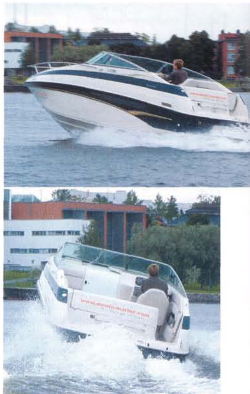
Sopra, due situazioni in cui l'ACS è in azione. In alto, quando la barca accelera il sistema regola i flap in modo da portarla in planata. In basso regola l'assetto trasversale con onda e vento.
