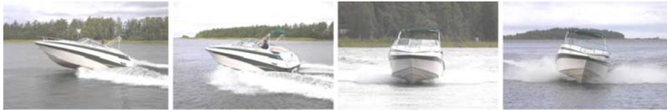
El ACS le releva a usted de dicha tarea. Al cambiar de rumbo, cuando el viento cambia de dirección o cuando los tripulantes se mueven, se corrige automáticamente el comportamiento de la embarcación mediante el ajuste de los flaps.
