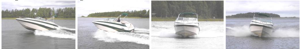
Das Trimmlagen Korrektursystem (ACS) nimmt Ihnen diese Arbeit ab. Trimmlagenänderungen durch Wind, neuen Kurs oder geänderte Sitzpositionen von Passagieren werden automatisch durch das System ausgeglichen.
