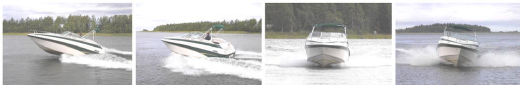
El ACS le releva a usted de dicha tarea. Al cambiar de rumbo, cuando el viento cambia de dirección o cuando los tripulantes se mueven, se corrige automáticamente el comportamiento de la embarcación mediante el ajuste de flaps y del power trim.
