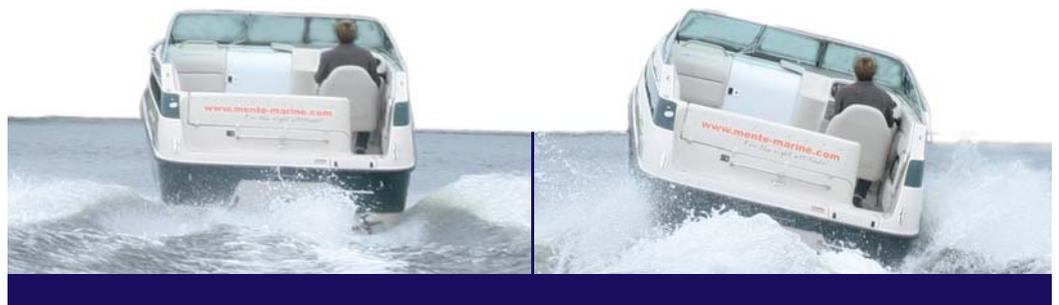
Vertrimmen - wie auf dem Bild rechts - ist im Automatikbetrieb nicht mehr möglich.
