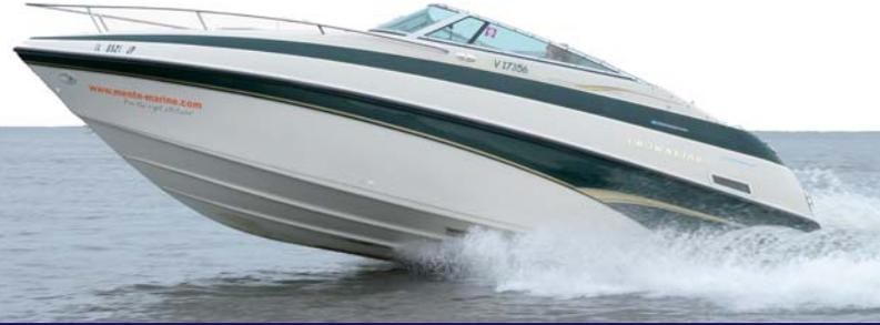
Beim Übergang von Verdränger - in Gleitfahrt hebt sich der bug mit eingeschalteter Automatik spürbar geringer als ohne.
